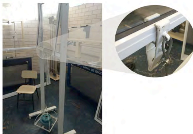
Figura 3 – Aparato para aplicação da carga na folha móvel da maxim-ar
