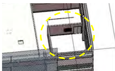
Figura 1 – Ausência de laje de cobertura na subestação
