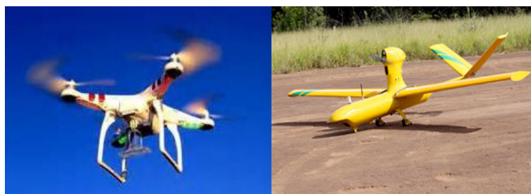
Figura 1: (a) VANT com quatro asas rotativas (quadricóptero); (b) modelo com asa fixa produzido pela AGX denominado VANT Arara.
