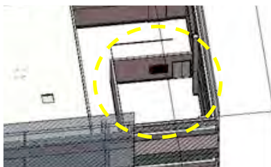
Figura 1 – Ausência de laje de cobertura na subestação
