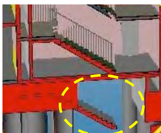
Figura 4 – Erro de modelagem – escada deslocada
