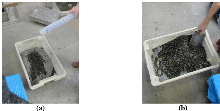
Figura 2 – Processo de saturação do AGRC. (a) molhagem do AGRC. (b) homogeneização do AGRC
