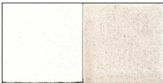
Figura 8 – Amostra T7-MEC inicial (esquerda) e após 12 meses (direita) de exposição ao intemperismo natural.
