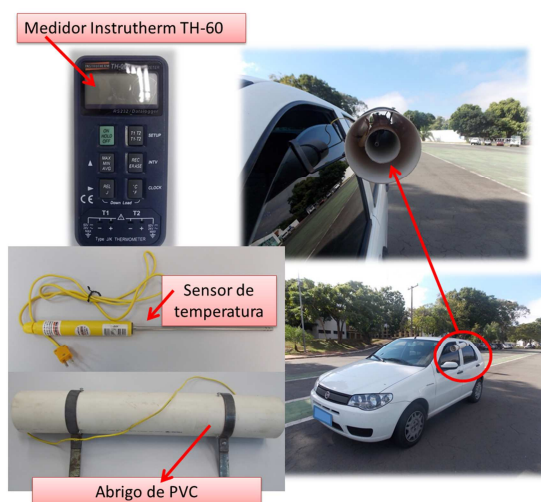
Figura 2- Instrumentação para as medições móveis de temperatura do ar
