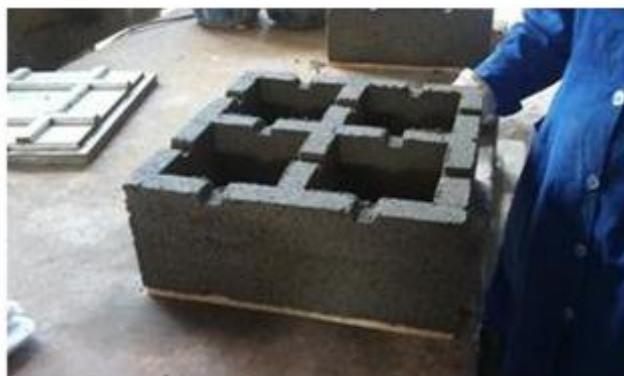
Figura 4 – Primeiros blocos TEVA produzidos com paredes com 3 cm (12 kg).
