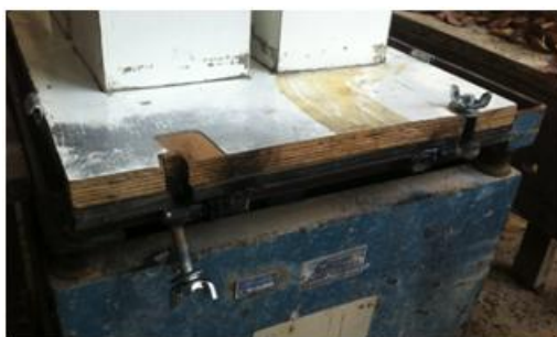
Figura 7 – Novo sistema de fixação da peça dos fundos do molde à mesa vibratória.
