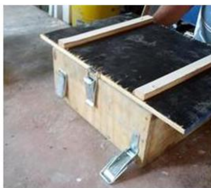
Figura 5– Travas utilizadas entre o molde e a base escrava.
