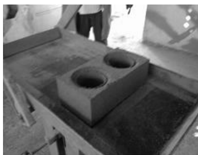
b) extrusão do bloco
