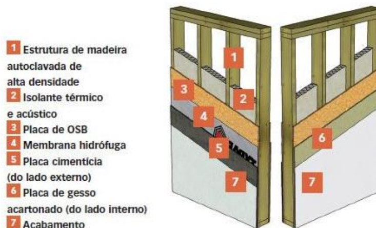
Figura 1 – Composição do elemento de parede do sistema Tecverde
