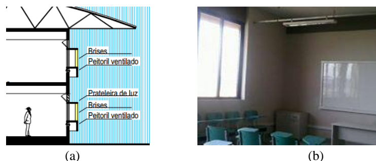
Figura 6 – (a) Esquema de prateleira de luz e (b) Destaque da incidência solar no quadro branco
