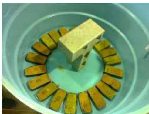
Figura 5 – Corpos de prova colocados em lâmina d'água de 1 cm de profundidade
