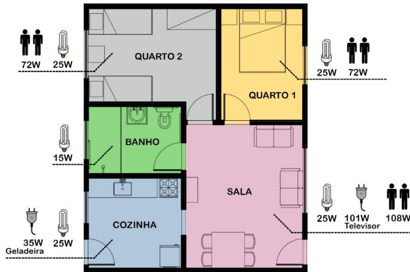
Figura 4 – Cargas internas na edificação
