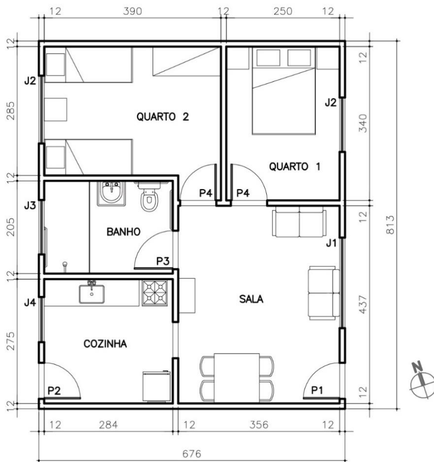
Figura 1 – Planta baixa da edificação
