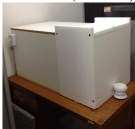
Figura 5- Câmara térmica (exterior)
