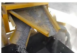
Figura 1 – Processo de britagem RCD
