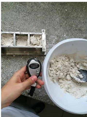
Figura 3 – Tentativa de moldagem de corpos de prova com 100% de resíduo sem aditivo retardador de pega
