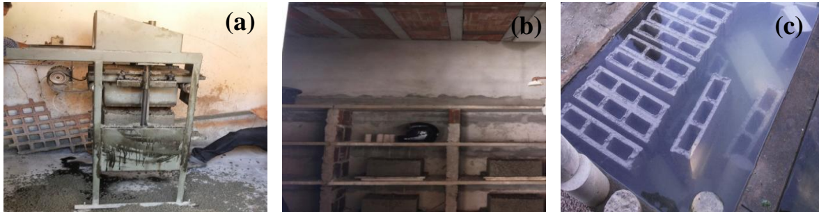
Figura 03- (a) máquina vibro-prensa semi-automática; (b) câmara úmida; (c) tanques de cura
