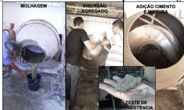
Figura 02 - Mistura do material para a moldagem dos blocos EVA
