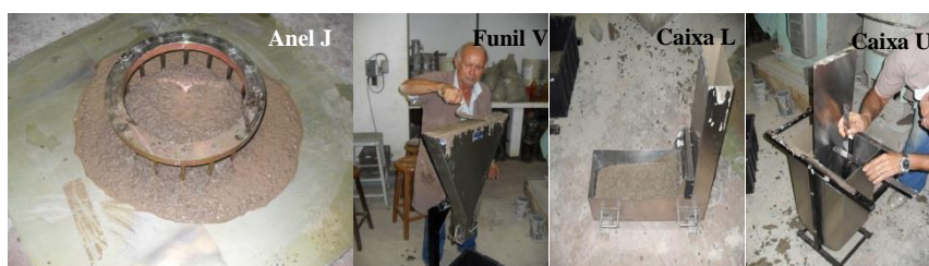
Figura 7- Ensaios para verificar a autoadensabilidade do concreto.
