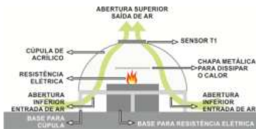
Figura 4: Etapa 3 do experimento prático de ventilação por efeito chaminé
