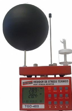
Figura 2 – Aparelho de medidor de Stress Térmico utilizado
