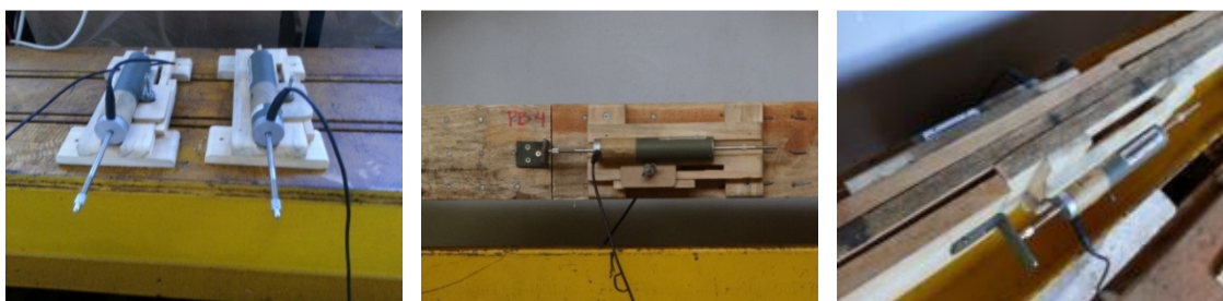
Figura 6. Fotos dos LVDTs, vista frontal e superior deles instalados nos modelos.
