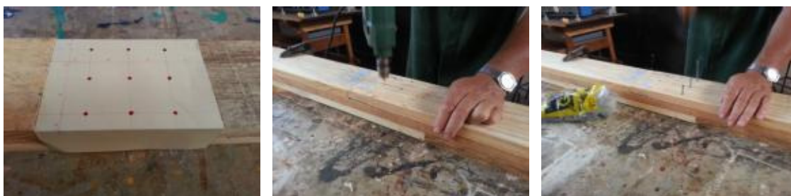
Figura 2. Fotos do gabarito, pré-furação e pregação dos modelos.
