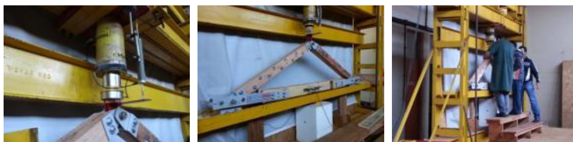
Figura 5. Fotos da célula de carga, pórtico metálico e montagem do aparato.
