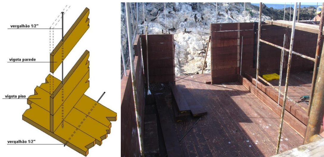
Figura 5 – Sistema construtivo viga-laje em madeira (Arquipélago de São Pedro e São Paulo)
