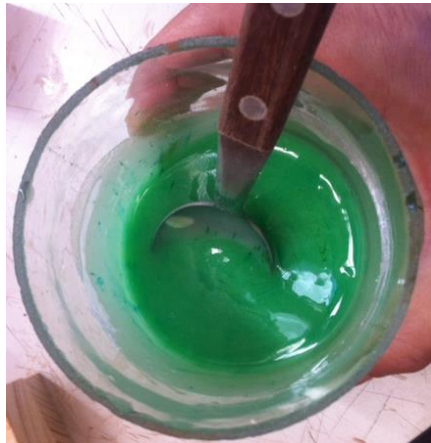
Figura 3. Preparação do adesivo Ureia-formaldeído com adição de corante.
