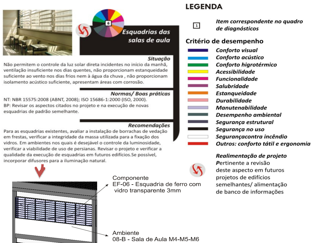
Figura 2. Detalhe do diagnóstico elaborado a partir da aplicação de APO para o componente EF-06 e a Sala de Aula 8B
