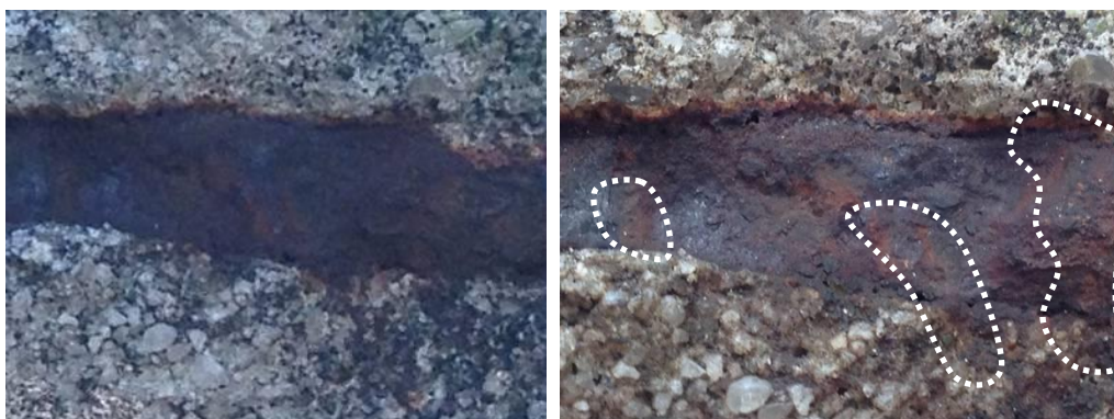
Figura 9 – Área de mureta antes e após o ensaio com solução de nitrato de prata, à esquerda e à direita, respectivamente. À direita podem ser vistos vários pontos brancos (cristais de sal formados com a reação)
