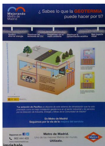
Figura 3 – Ilustração do sistema geotérmico na Estação de metrô Pacífico, em Madri, Espanha
