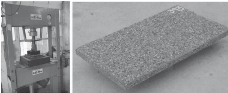
Figura 2- Prensa para compactar la mezcla y panel terminado.
