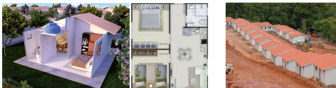
Figura 3- Habitação no sistema modular em aço, localizada na região Serrana do Rio de Janeiro. Etapas: projeto e casas na fase de execução
