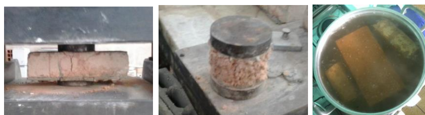
Figura 8 – (a) Teste de compressão; (b) Placas de Aço; (c) Teste de Absorção
