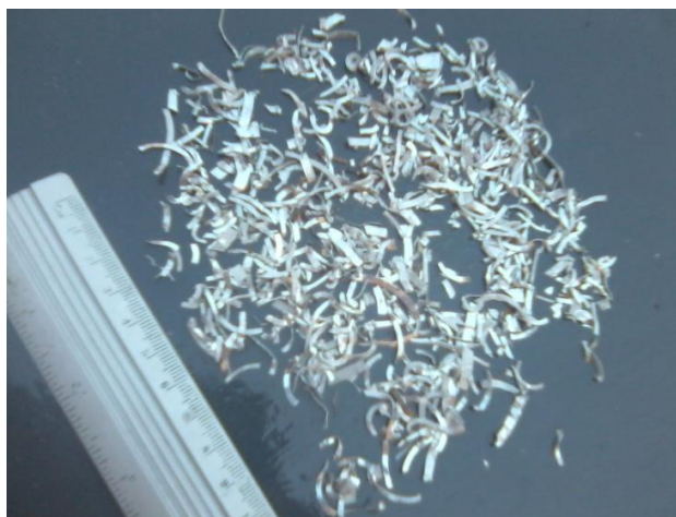
Figura 01 - Fibras de alumínio incorporadas na argamassa, com Ø entre 1,00 mm e 2,0 mm e variabilidade de l, entre 14,0 mm e 26,0 mm.
