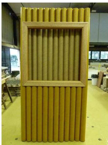
Figura 7 – Painel de vedação vertical de tubos de papelão com esquadria.
