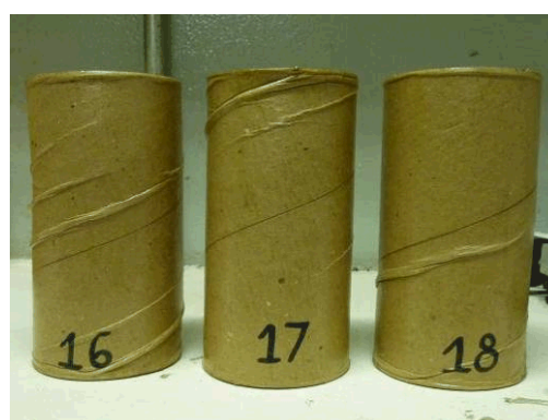
Figuras 10 e 11 - Corpos de prova antes e após o ensaio de resistência à compressão.
