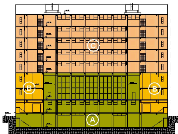
Figura 3a: Zonificación de calefacción
