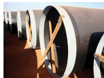
Figura 6 - Problema nos tirantes deixando os tubos ovalizados no transporte
