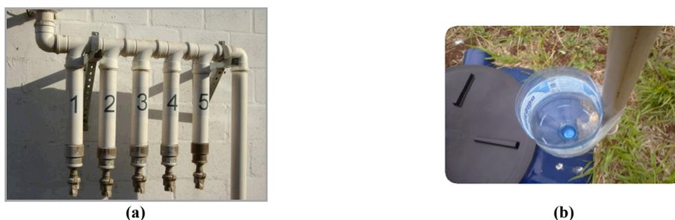
Figura 2 – Pontos de coleta das amostras de água: (a) coberturas (b) diretamente da atmosfera.
