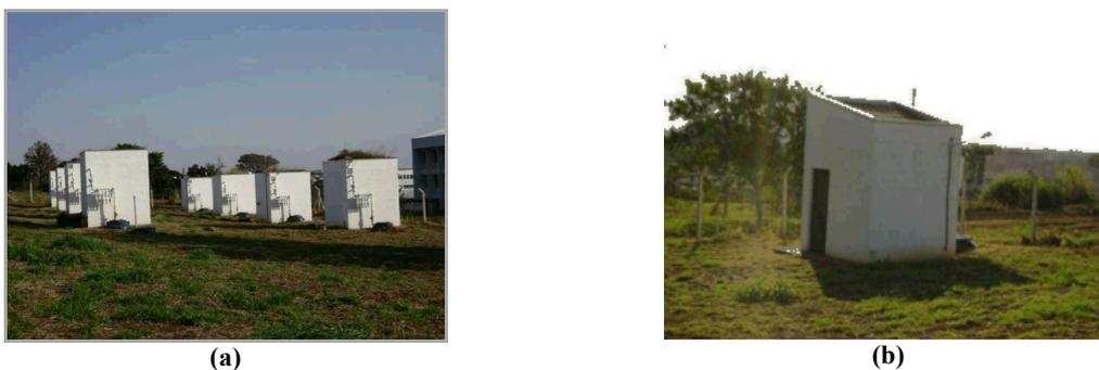
Figura 1 – Coberturas verdes (a) e convencional (b) instaladas nas células-teste.
