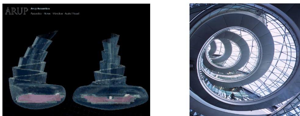
Figura 3 – Novo teste, agora com a rampa (à esquerda) e a mesma já construída (à direita). Sua implantação surgiu como solução de projeto após simulações acústicas .
