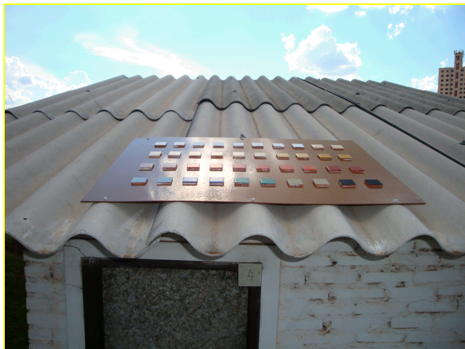
(b) Amostras aderidas em placa sobre protótipo
