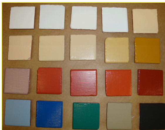
Figura 1 – Amostras de tintas expostas ao intemperismo natural
