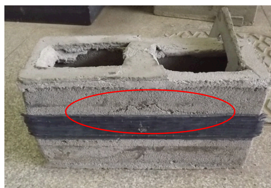
Figura 5. (a) Ruptura predominante do bloco sem reforço; (b) Ruptura predominante do bloco reforçado
