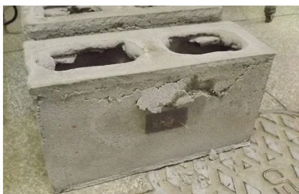
Figura 5. (a) Ruptura predominante do bloco sem reforço; (b) Ruptura predominante do bloco reforçado
