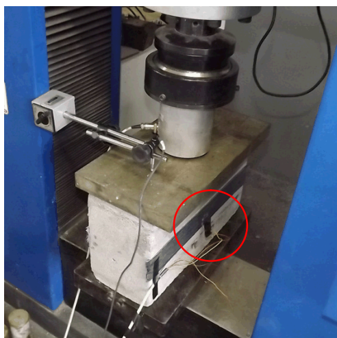
Figura 3. Bloco com reforço durante ensaio
