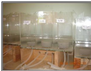
Figura 2-Amostras cilíndricas dentro dos tanques submersas no líquido lixiviante; razão L/S = 5
