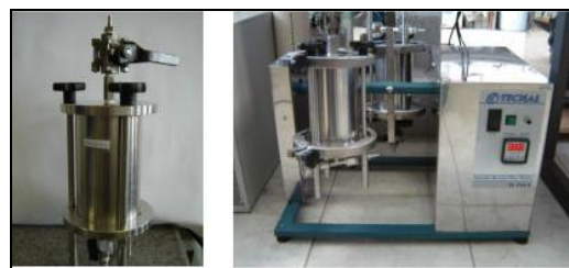
Figura 3- (a) Determinação da Solução de Extração e (b) Cilindro extrator e aparato para a rotação FONTE: (a) Descrição na NBR 10005:2004 e (b) SCHAEFER C. O. (2007).
