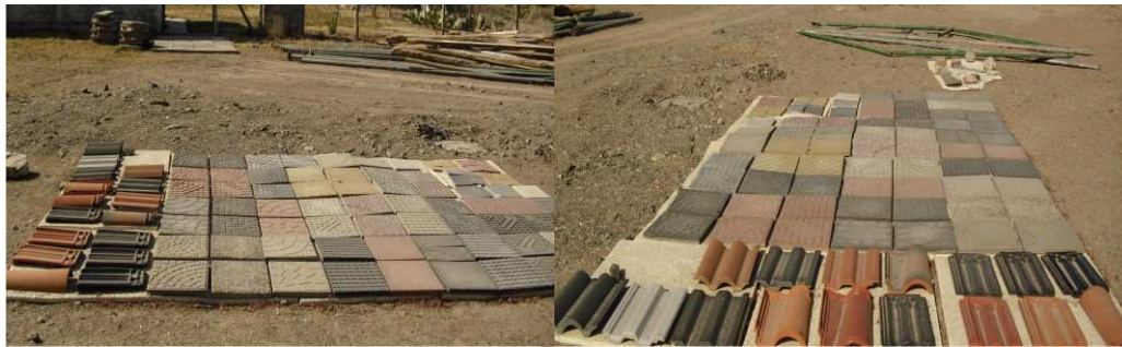
Figura 3. Evaluación térmica y óptica de los materiales en explanada.
