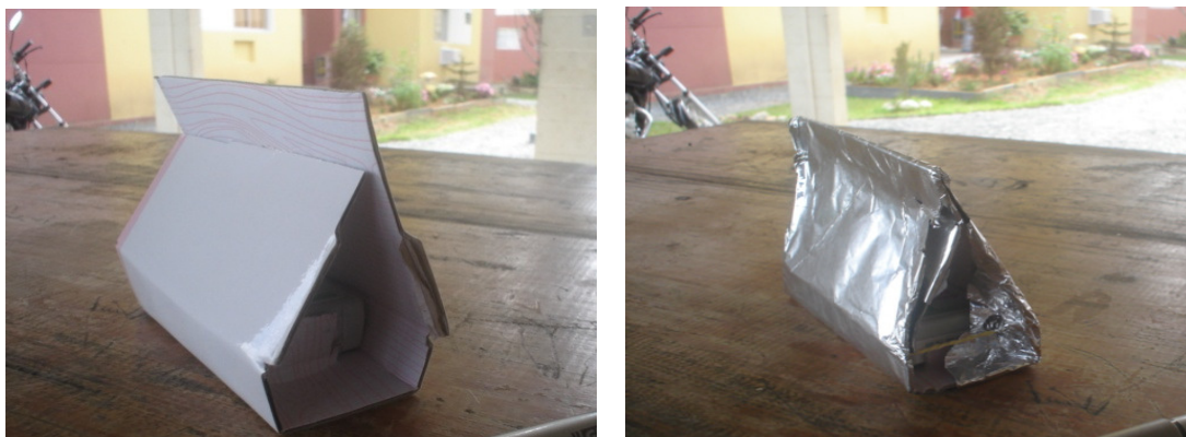
Figura 2: Preparação do dispositivo de proteção para os equipamentos da área externa.
