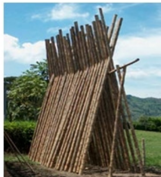
Figura 2: Detalle de la colocación del bambú para su secado y almacenamiento
