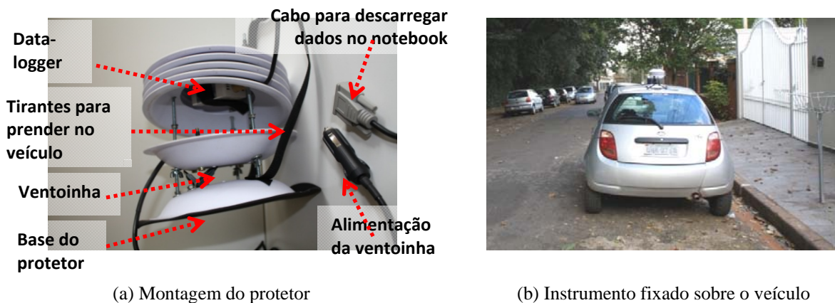
Figura 3: Sensor de temperatura e umidade protegido e ventilado naturalmente e mecanicamente fixado sobre um veículo automotor para registros móveis.
