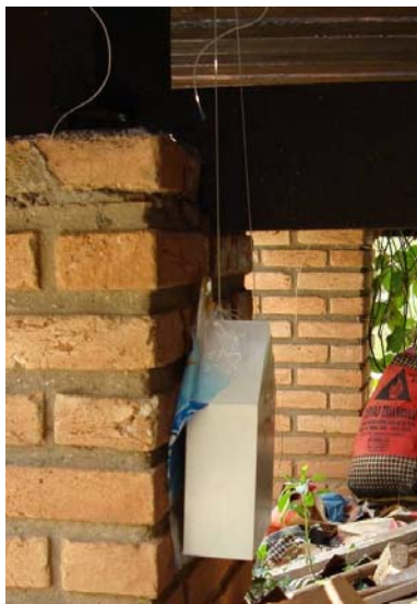
Figura 9: Sensor ext. 2- localizado à sombra, embaixo do deck de madeira externo.
