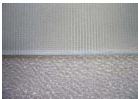
Figura 2 - Comparação entre os vidros: Boreal (inferior) e Miniboreal (superior)
