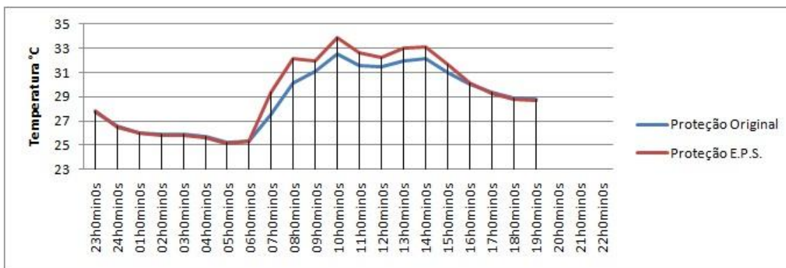
Figura 05: Teste 04 – Comparativo entre a proteção original e a proteção de EPS.
