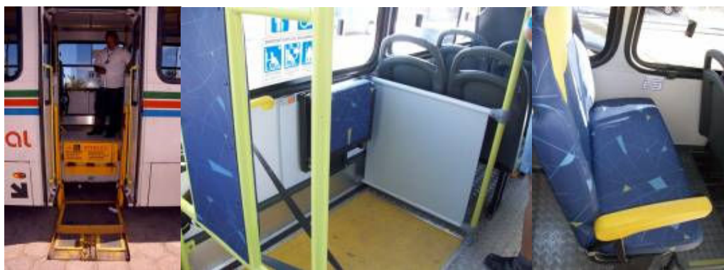
Figuras 01, 02 e 03. Plataforma elevatória; área para cadeira de rodas; poltronas para gestantes e obesos.
