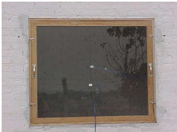
Figura 4 – Termopares colados no vidro
