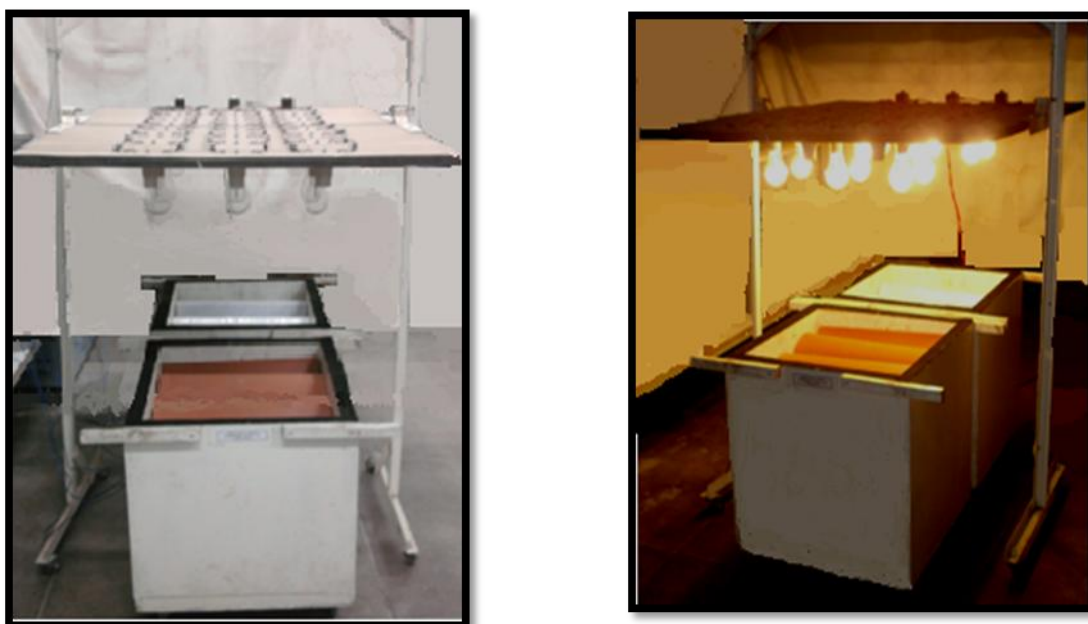
Figura 7- Câmaras de ensaios de desempenho térmico com as telhas estudadas.
