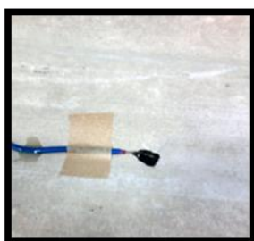
Figura 4- Foto do termopar fixado na superfície inferior da telha.
