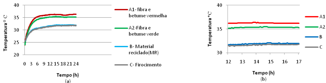
Figura 13- Gráfico das Temperaturas de bulbo seco no interior das câmaras.
