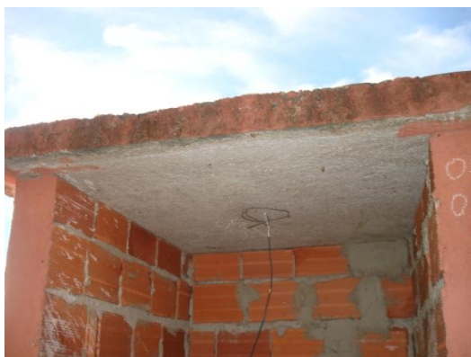
Figura 04 – Termopar para medição da temperatura superficial interna da laje de cobertura
