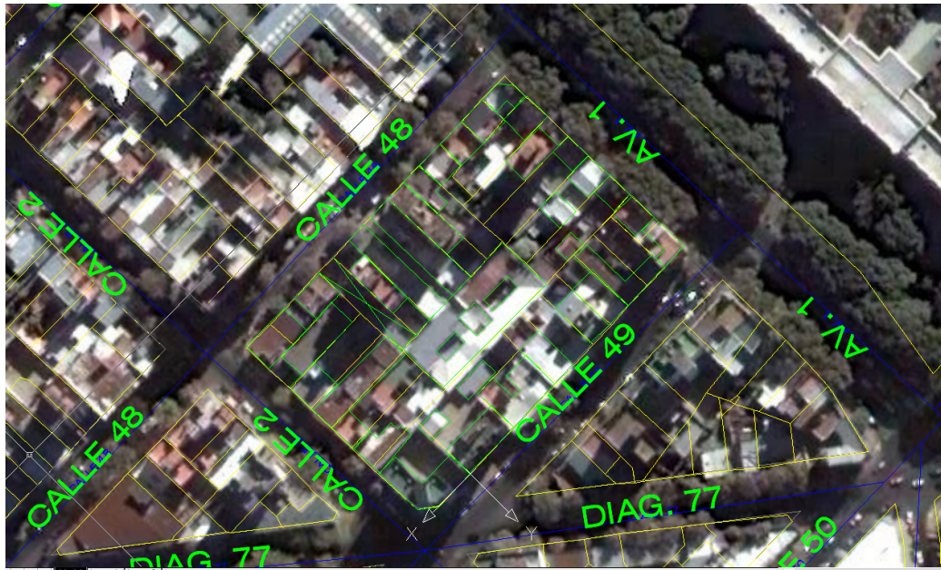
Figura 11: Dibujo de las edificaciones con el programa AutoCAD sobre imágenes del Google Earth.
