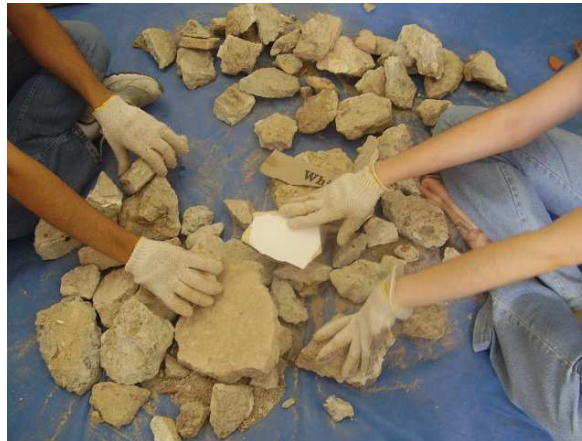
Figura 2 – Composição gravimétrica do RCD.
