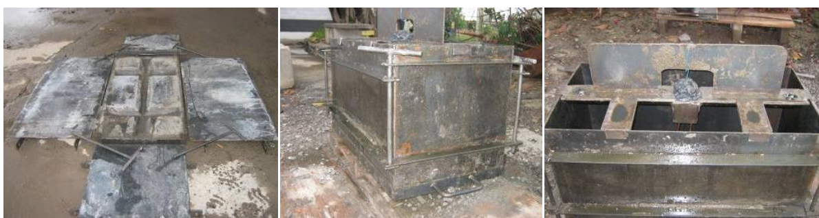
Figura 4 – Modelo de fôrma adotado para produção dos blocos
